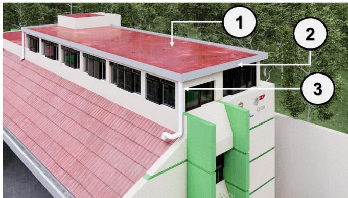
La lluvia es captada en primer lugar por la *primera zona de captación* (1), dirigiéndose hacia las *primeras canaletas* (2) del sistema y siendo redireccionadas por las *primeras bajantes* (3)(4) hacia la siguiente zona de captación.
