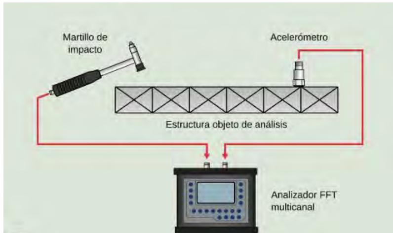
Figura 13 Arreglo experimental para un análisis modal tipo bump test [48].
