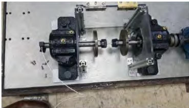
Figura 25 Banco experimental para pruebas de fatiga en condiciones de resonancia [39].
