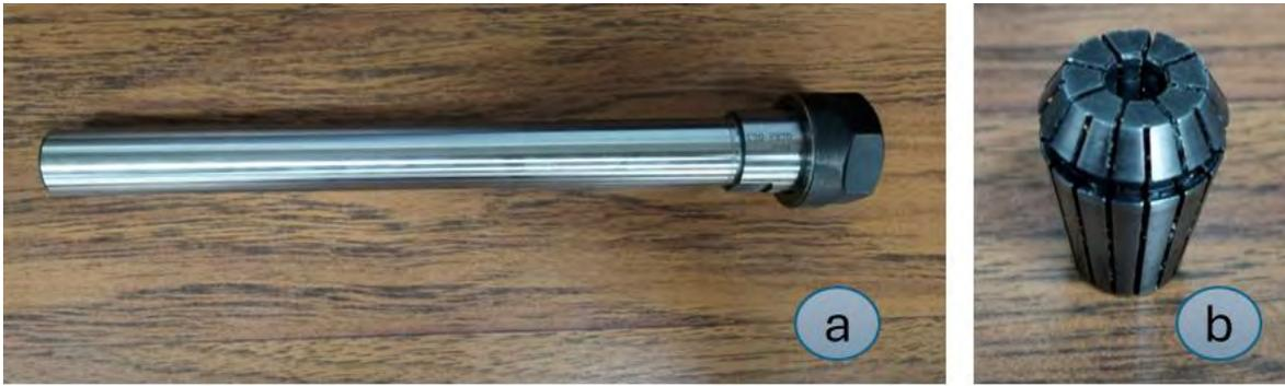
Figura 31 a. Barra de extensión ER y b. Sujetador collet
