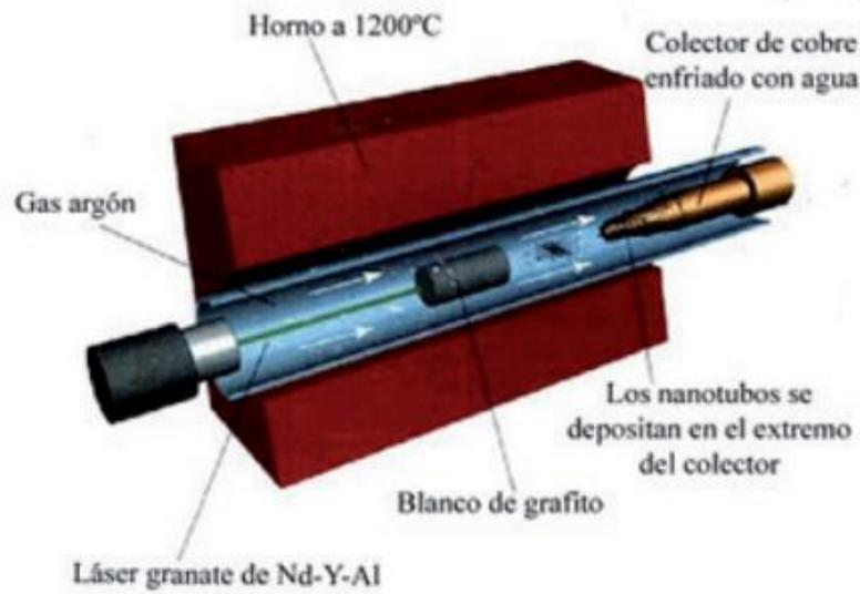
Figura 4 Esquema del equipo de ablación láser [14]
