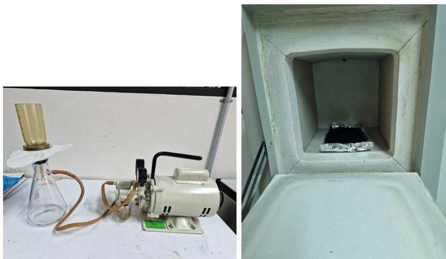
**Figura 18** Sistema de filtrado al vacío y mufla
