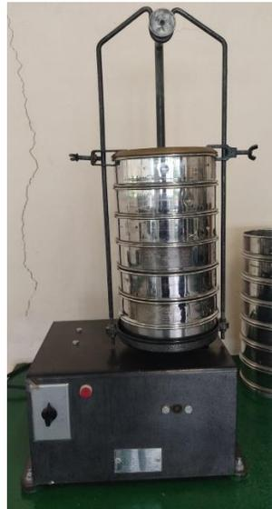
Figura 12 Equipo para determinación de granulometría
