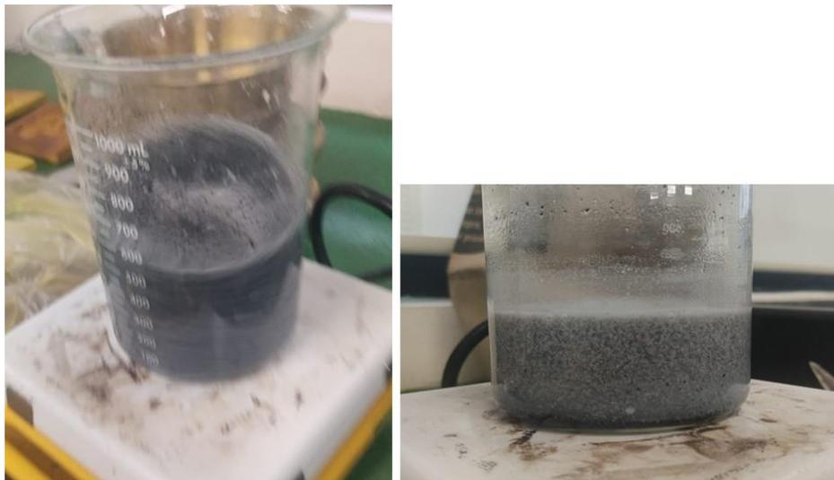
**Figura 19 Mezcla de NTC funcionalizados con tensoactivo**
