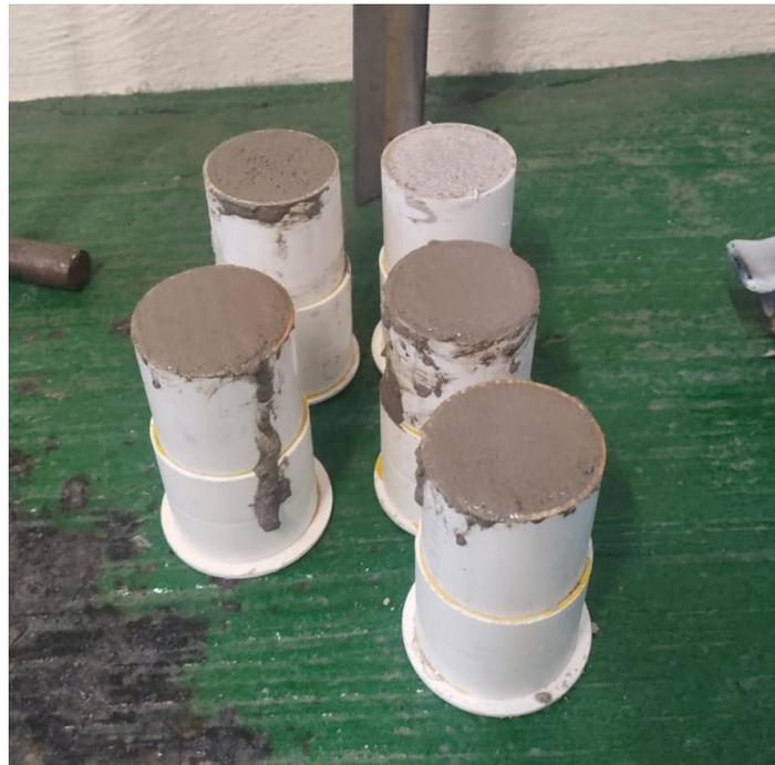
**Figura 20** Cilindros con mezcla de arena, cemento y agua
