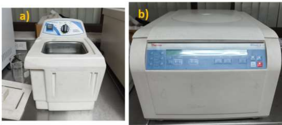
Figura 2.5 Equipos empleados en la purificación de los nanomateriales, a) baño ultrasónico y b) centrífuga.
