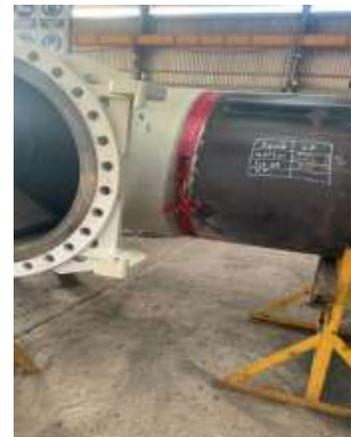
**Ilustración 8 Spool de diámetro mayor en preparación para ser radiada.**
