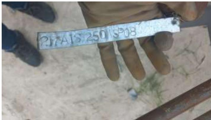
Ilustración 12 Placa de un *spool*
