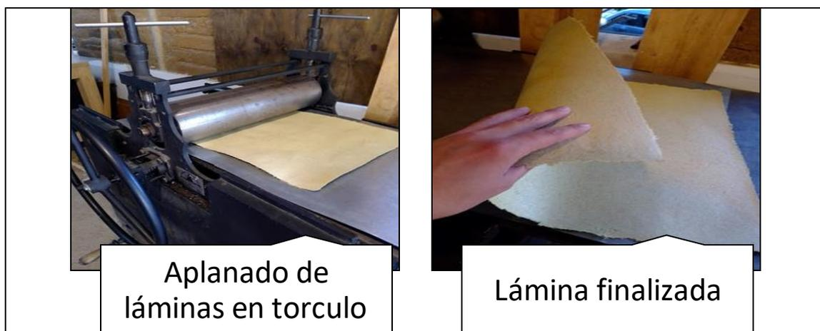
A las láminas de hoja de elote obtenidas se les midió el grosor, tomando una superficie de  $14 \text{ cm}^2$  y con ayuda de un micrómetro se tomaron 10 puntos aleatorios obteniendo un promedio de estos.
