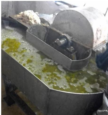
**Moldeado de láminas:** La pulpa se colocó en recipientes grandes, dentro de los cuales se introdujeron en bastidores con mallas finas para que quede atrapada la mayor cantidad de pulpa. Posteriormente, el bastidor se puso sobre una placa metálica con yeso, y, finalmente una tela de fieltro (Figura 2.6). Este proceso se repitió hasta que no se pudo retener pulpa en el bastidor.
