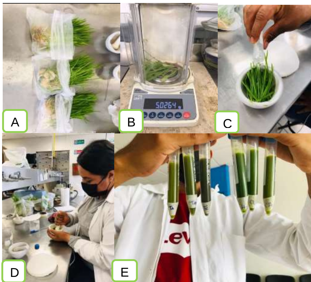
Figura 3.24 - A), B) y C) Selección de la muestra, Peso de la muestra y Colocación en mortero, D) Trituración de la muestra y E) Agitación de la muestra para determinar si presenta saponinas.
