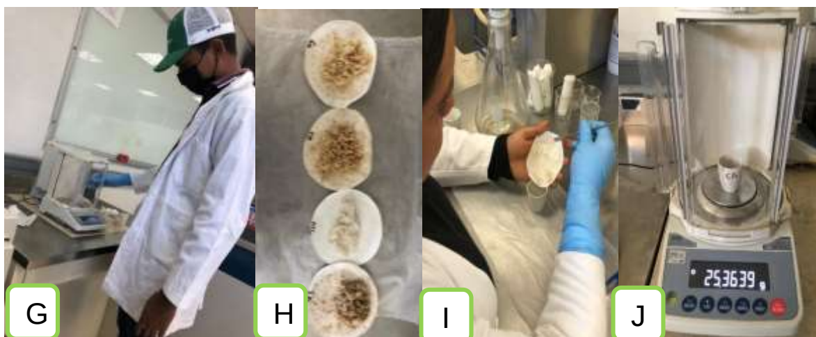
Figura 3.20 - A) Preparación de solución, B) Muestras en ebullición, C) Filtración de muestra, D) Lavado de muestra, E) Precalentado de crisoles, F) Crisol en el desecador, G) Pesado de los crisoles sin muestra, H) Fibra obtenida, H) Colocación de fibra en el crisol y J) Pesado del crisol con muestra.
