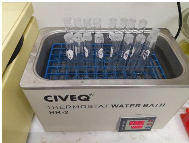
**Figura 19.** Muestras en baño termostato a 45°C por 15 min.
