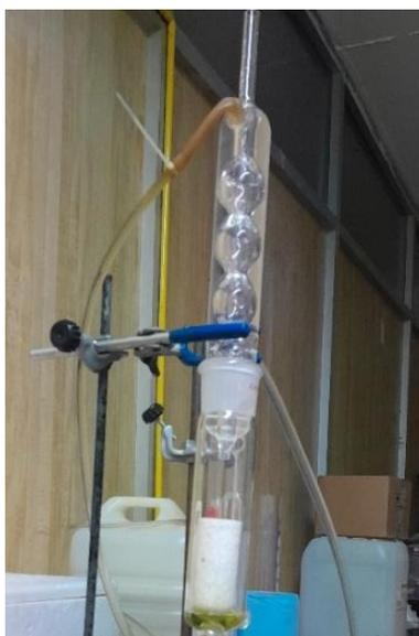
**Figura 9.** Conexión de las mangueras de entrada y salida del equipo.
