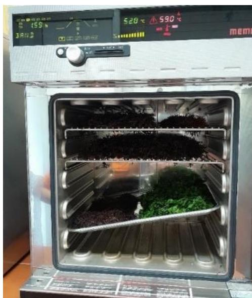
**Figura 4.** Algas en horno de secado a  $60^{\circ}\text{C}$ .
