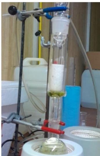
**Figura 7.** Llenado de matraz de fondo plano con el solvente etanol al 96%.
