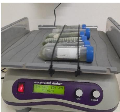
**Figura 13.** Muestras en agitador a 150 rpm.
