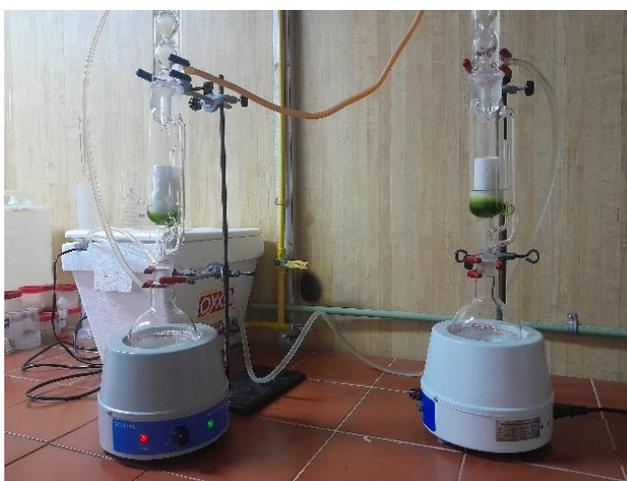
**Figura 10.** Instalación completa del equipo Soxhlet.
