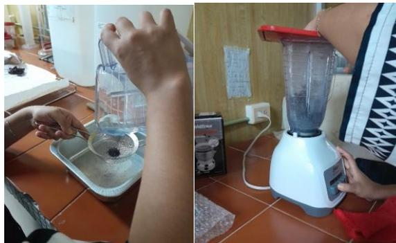
**Figura 5.** Pulverización y tamizado de las muestras sólidas.
