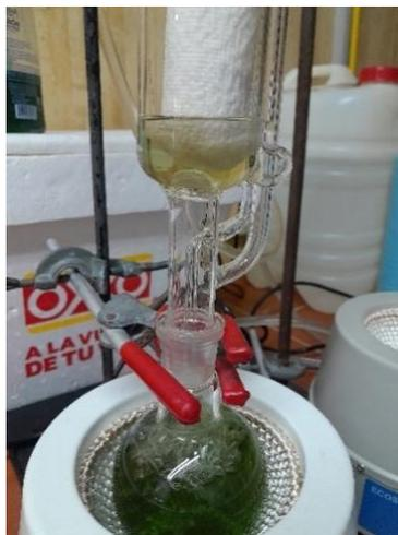
**Figura 8.** Calentamiento del solvente.
