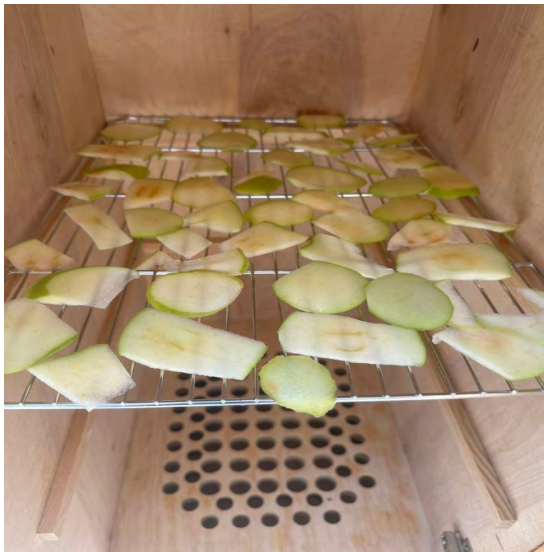
Figura 4.7 Imágenes propias: Deshidratación de manzana Granny Smith en cámara de secado (Prototipo II)
