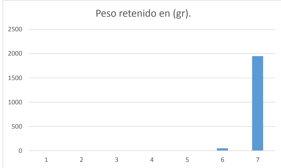
Figura 4.23. Distribución de tamaño de partículas de la muestra de suelo M1 colectada sobre la superficie, 0 cm de profundidad, 60 cm.
