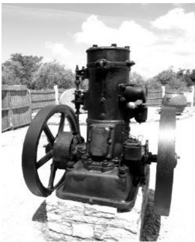
Fig.7 (antiguo motor diésel estacionario de un único cilindro).
