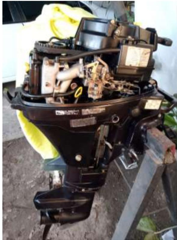
**Fotografía 8** verificaciones del sistema eléctrico y sistema de combustible en motor fuera de borda de 75 Hp
