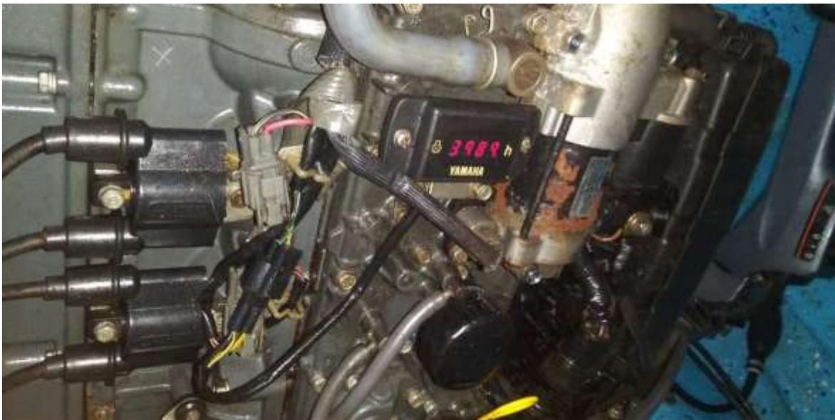
**Fotografía 9** Revisión, limpieza y calibración periódica del carburador y las bujías a motor fuera de borda 125 Hp con 3989 Hrs de trabajo
