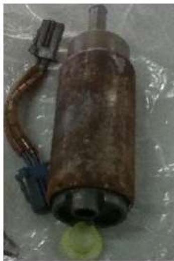
**Imagen 8** Efecto de corrosión en la bomba de alta presión
