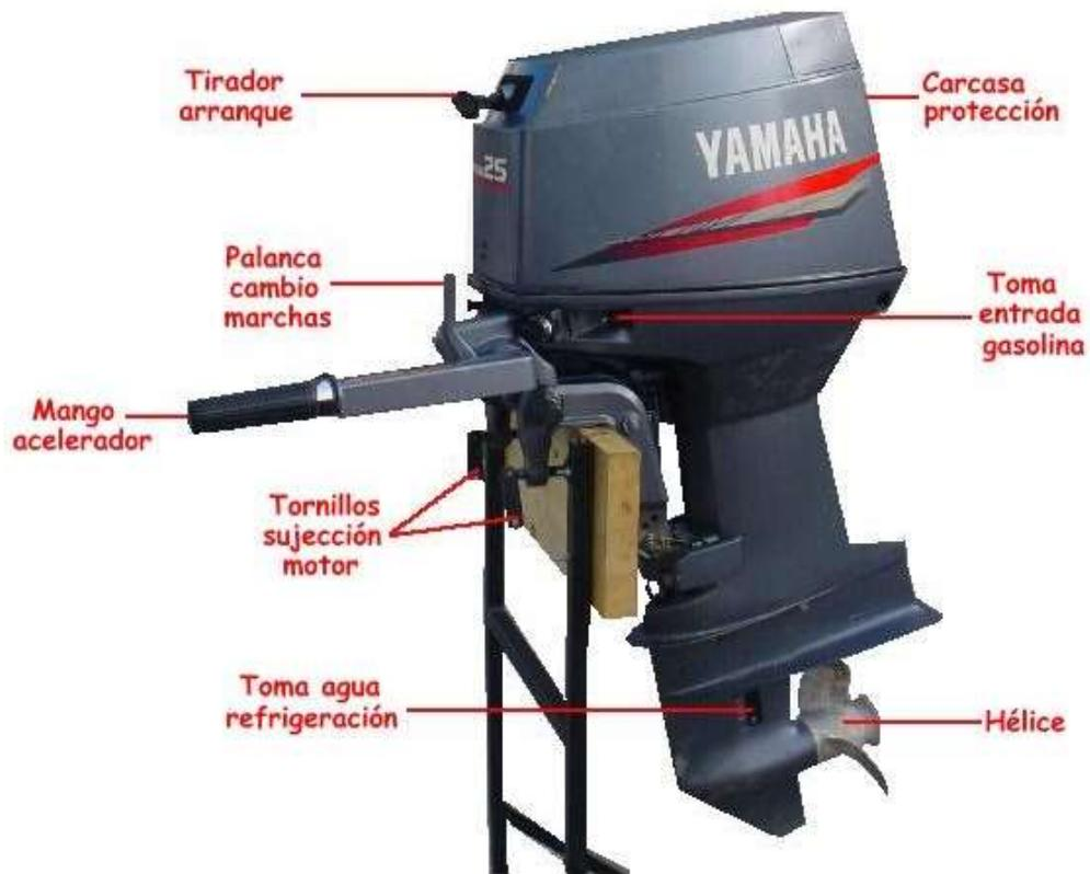
**Ilustración 5** Partes de un motor fuera de borda.
