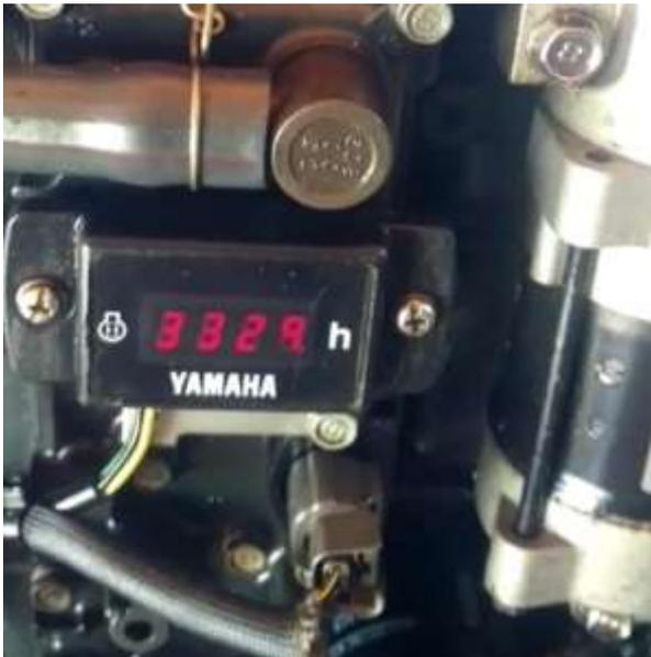
**Fotografía 5** Mantenimiento preventivo a motor fuera de borda 75 Hp con 3329 Hrs.
