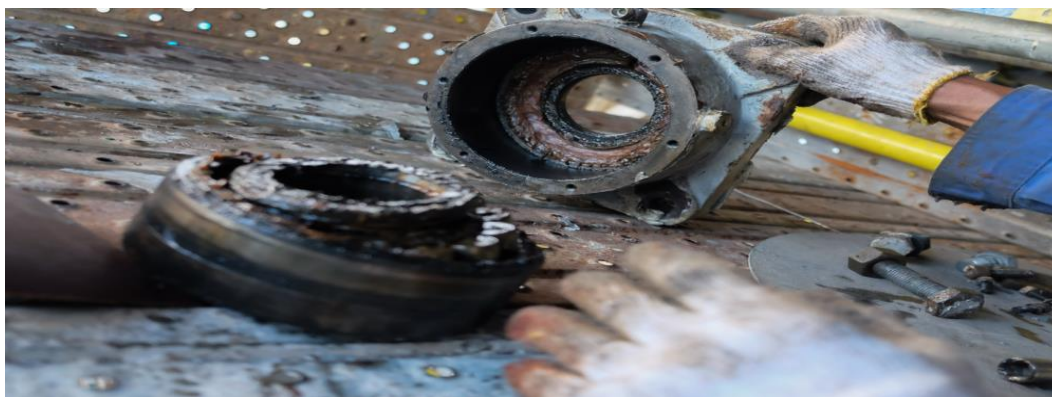
Figura 24: Rodamiento defectuoso desmontado. Fuente: Tablas y información de Rodamientos
