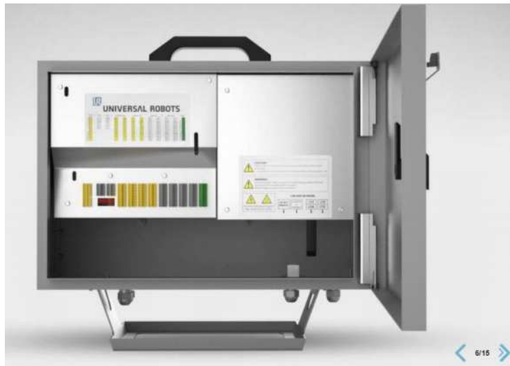
Figura 4-2 Módulo de comunicación, entradas y salidas digitales y analógicas
