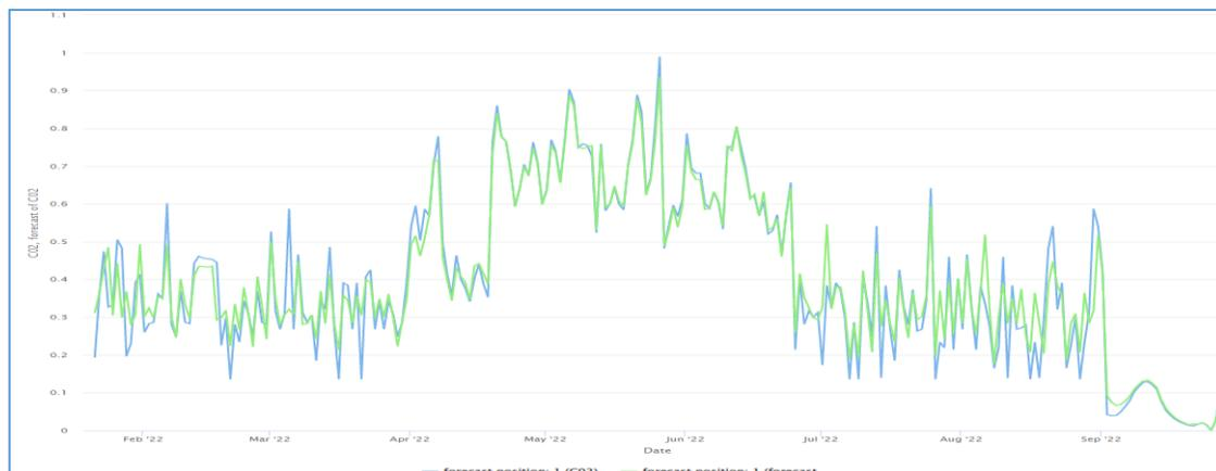
Figura 4.4 Comparación entre datos reales de  $CO_2$  y el método ARIMA
