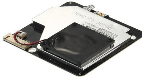
Figura 2.3 Sensor de partículas (Nova PM Sensor SDS011)
