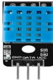
Figura 2.4 Sensor de humedad y temperatura.
