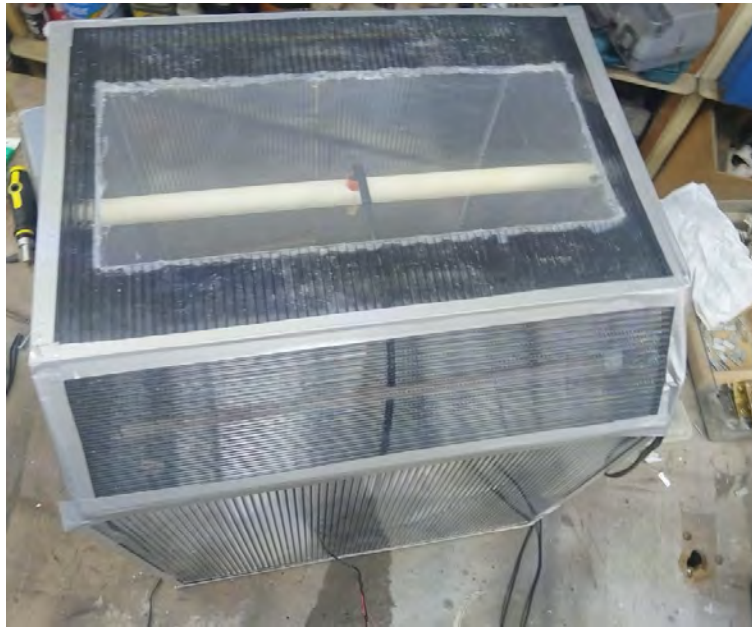
Figura 3.24: Construcción terminada, con sistema de riego y ventiladores
