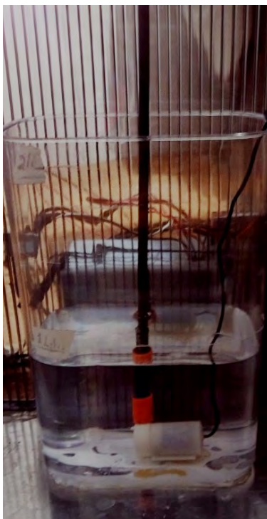
Figura 3.29: Tanque de agua con bomba, sistema de riego
