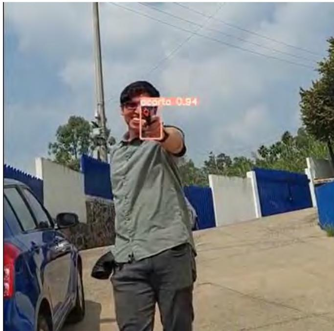
Figura 5.20 Imagen ilustrativa de la detección con YOLO en videos grabados en estacionamiento del CENIDET 1
