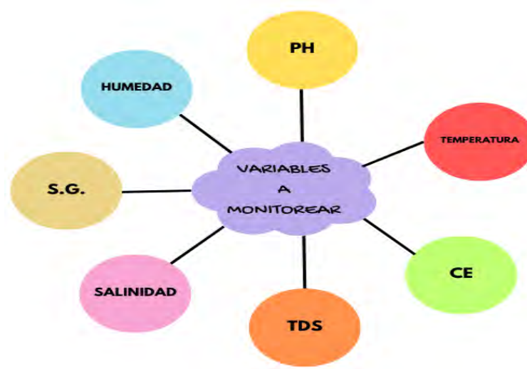
Figura 2.15: Variables a monitorear en el sistema hidropónico.
