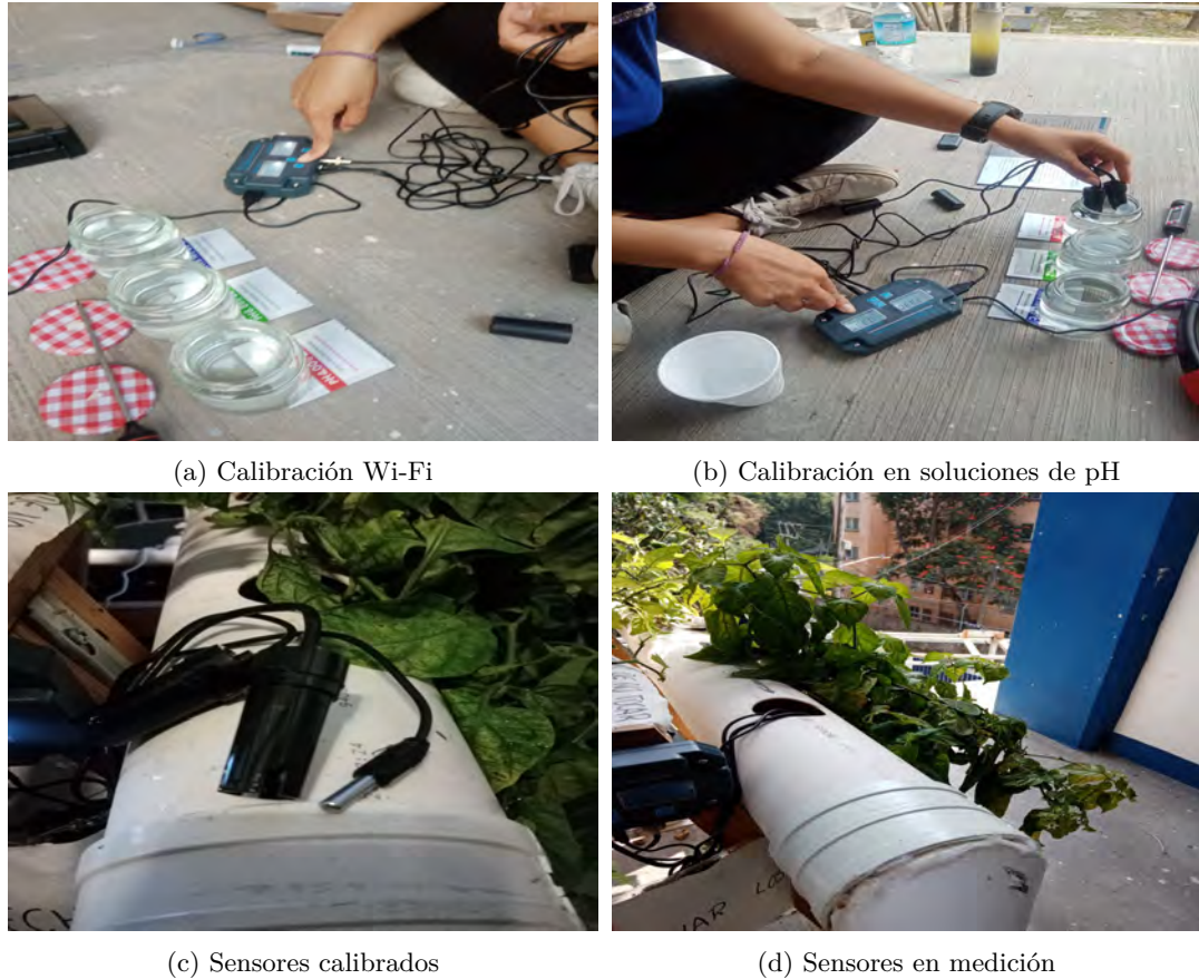
Figura 4.19: Calibración del sensor pH-W3988.
