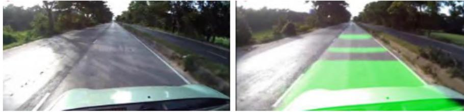
Figura 2.11 Detección de carril con CNN[91].
