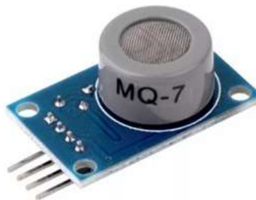
Figura 4. Sensor MQ-7 para medir monóxido de carbono (Mechatronics, 2018).
