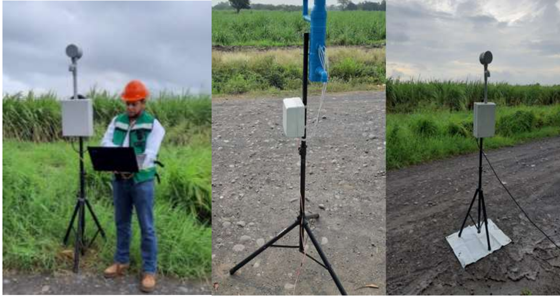
Figura 19: Monitoreo de CO, temperatura y humedad relativa en temporada de zafra y no zafra. Fuente propia.
