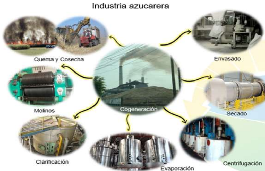
Figura 11. Proceso de producción de azúcar. Fuente propia.
