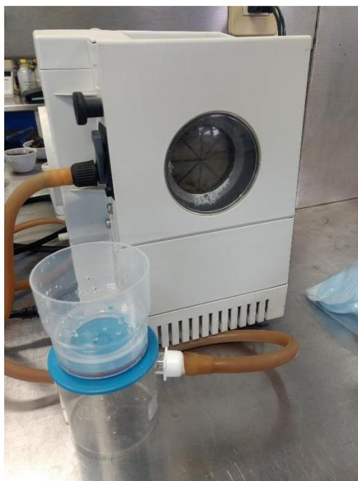
**Figura 9.** Bomba de vacío, matraz y filtro de nitrocelulosa para filtrar muestras de músculo de pez león.
