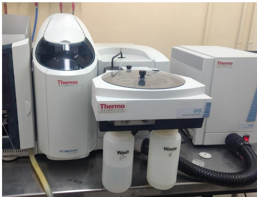
**Figura 10.** Espectrofotómetro de absorción atómica de horno de grafito Thermo Scientific ICE AAS 3500.
