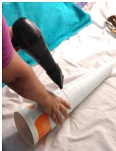
**Figura 32.** Calentado el material para moldear.
