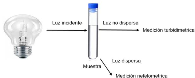
**Figura 3.** Diagrama de un sistema para la medición de turbidez
