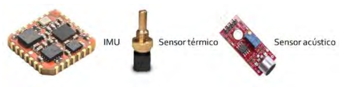
Figura 25. Sensores utilizados en la detección de fallas.
