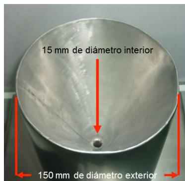
Figura 26.- Cilindro con embudo interno.
