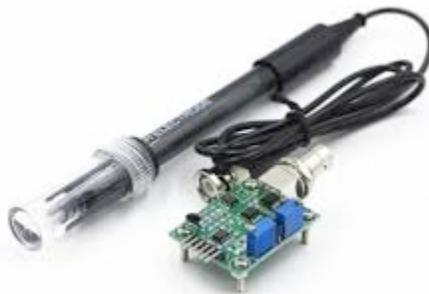
Figura 16.- Electrodo y módulo de pH
