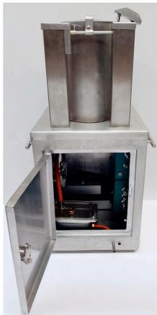
La obtención de datos se realizó con un electrodo o sensor para la medición de pH y se obtuvieron datos numéricos en acidez de 4 y 7 con solución buffer para calibración. Estas pruebas se realizaron en el Laboratorio de Investigación de Recursos Acuáticos (LIRA). Se necesitó de módulos Arduino para la realización de este trabajo y una tarjeta SD en donde toda la información es resguardada para después descargarla en una PC.
