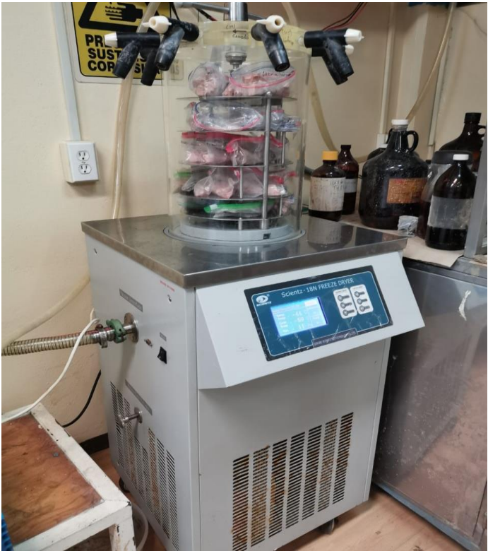
FIGURA 10. Liofilizadora Scientz-18N FREEZE DRYER
