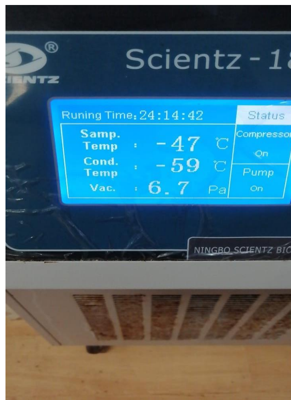
FIGURA 11. Estatus de temperatura y PA de la liofilizadora Scientz-18N FREEZE DRYER
