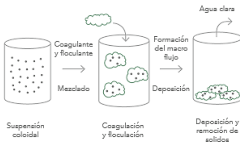
Figura 3. Coagulación y floculación de una suspensión coloidal al agregar un coagulante-floculante natural posterior a su mezcla, con la deposición posterior de la red a flocular. Fuente: Ramírez y Jaramillo (2015)
