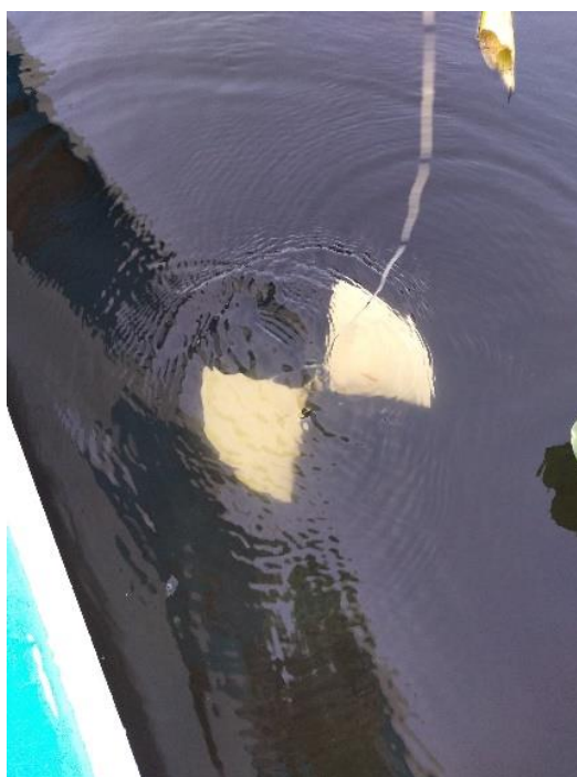
Figura 11. Toma de parámetros de Turbiedad con Disco de Secchi.
