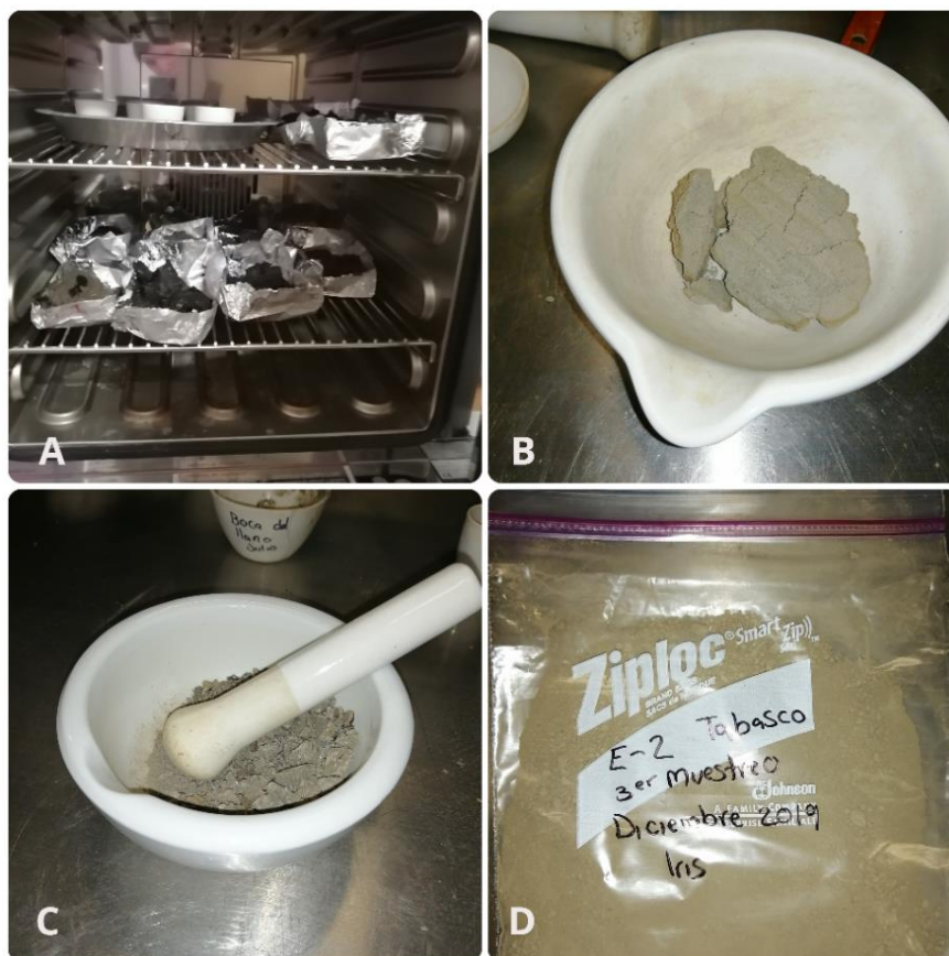
Figura 15. A) se observan las muestras de sedimento antes de ser secadas en un horno; B) se aprecia el sedimento seco; C) se procedió a triturar el sedimento con ayuda de un mortero por ultimo en la D) observamos el sedimento seco,
