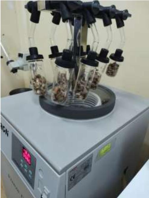
Figura 18: Equipo de liofilización
