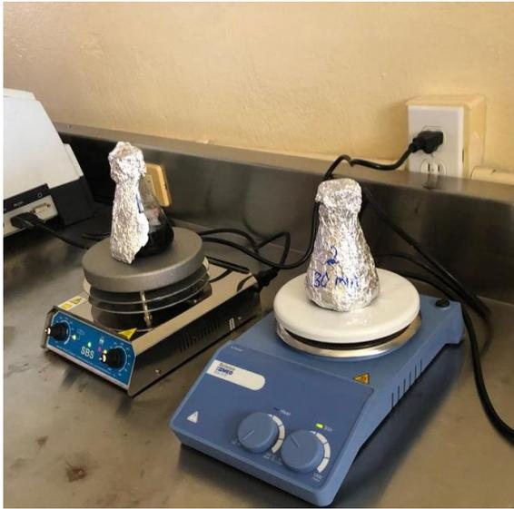
**Figura 29.** Agitación para la obtención de velocidad de agitación óptima
