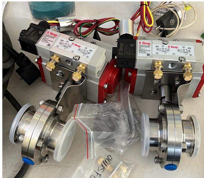
**Figura 5.10: Válvula de Mariposa Neumática BRAY CONTROLS**
