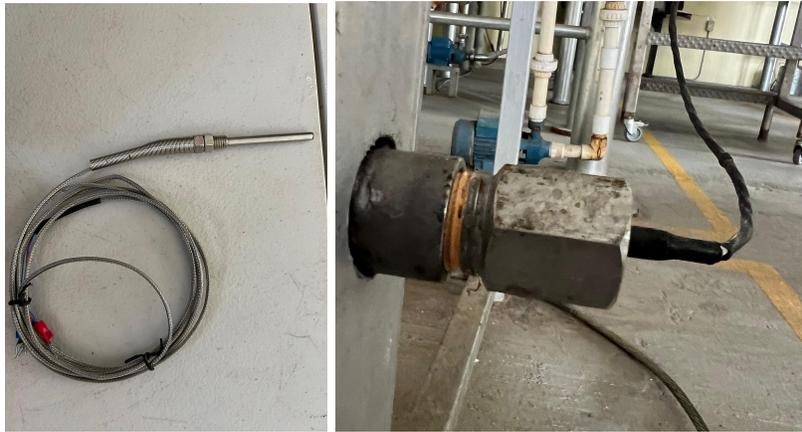
**Figura 5.9: Sensor de Temperatura y Termopozo**
