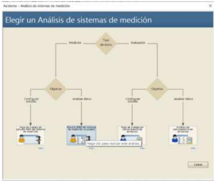
Paso 10. Seleccionar el tipo de Análisis a revisar. Para este caso seleccionar -> Estudio R&R del sistema de medición (cruzado).
