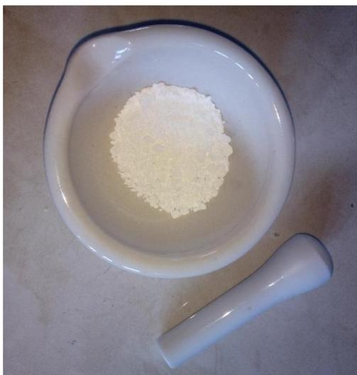
**Figura 6.** Nanopartículas obtenidas mediante el método Sol-Gel
