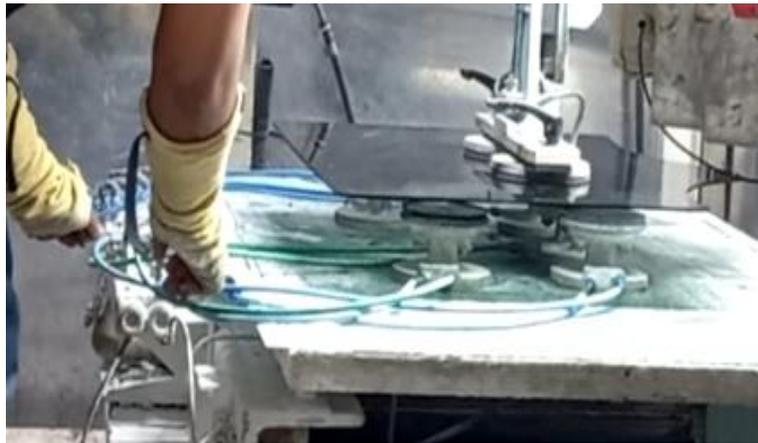
Figura 22: Operador buscando manguera neumática para ajustar un fijador en área de pulido (López, 2023).
