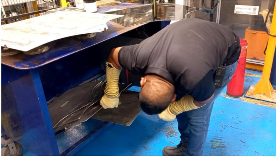
Figura 16: Operador buscando molde para comprobación de medidas perimetrales (López, 2023).
