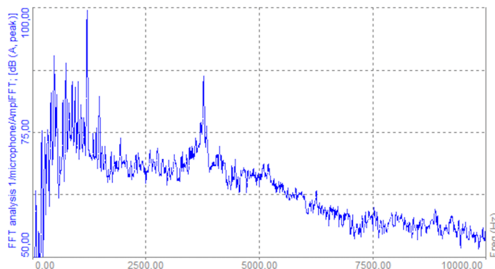
Ilustración 2 Ejemplo de un espectro en el dominio de la frecuencia de una señal de presión sonora medida en un entorno ruidoso
